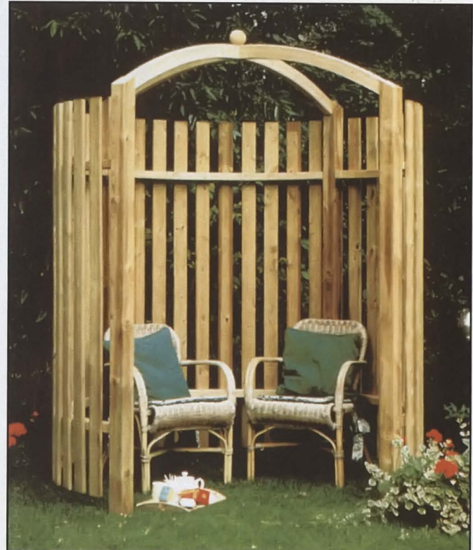
Эта круглая беседка имеет диаметр 2 м, чего вполне достаточно для размещения пары кресел. Четыре стойки с дугообразными слемами обшиты обычным штакетником. Венчают беседку арочные элементы.
