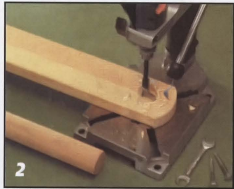
2 В стойках вертикального каркаса выбирают с помощью сверла Форстнера гнезда глубиной 15 мм под перекладины круглого сечения. Электродрель лучше закрепить в сверлильной стойке.
