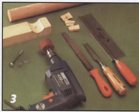
3 Круглую штангу к устройству для тренинга ног врезают в вертикальную деталь «маятника» на глубину 10 мм. Необходимое для этого углубление выбирают кольцевой пилой, стамеской или рашпилем.
