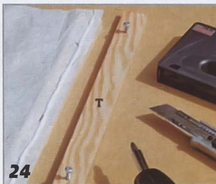
24 Один край выкроенного по размеру куска ткани закрепляют на клею и шурупах между двумя рейками Т.
