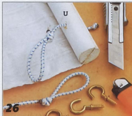
26 Для фиксации шторы в открытом положении предусмотрены шнуры, которые зацепляют за крючки.
